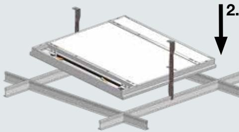
Der letzte Montageschritt beinhaltet das Ablegen des Models auf der gegenüberliegenden Kante. Das Modul durch leichten Zug oder Druck an eventuell vorhandenen Bauteilen der abgehängten Unterkonstruktion vorbeiführen und in der Endposition ablegen.
