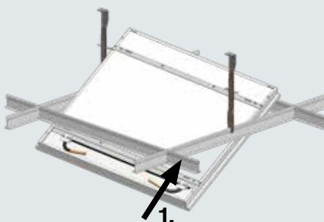
Das Modul oberhalb des Rasters zurückdrehen und mit einer Kante auf der abgehängten Unterkonstruktion ablegen.
