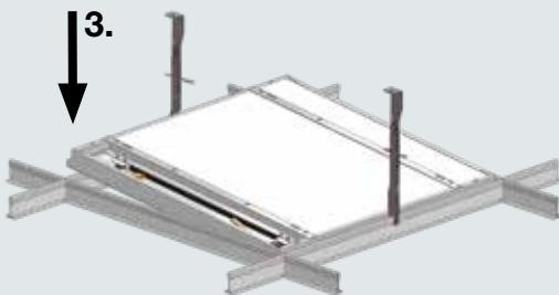
Im Anschluss das installierte Modul von unten auf einen parallelen und gleichmäßigen Verlauf im Raster kontrollieren.
