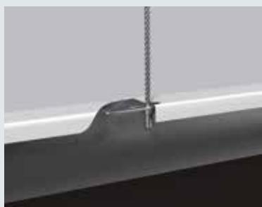
Das Aufhängesystem muss in allen Ebenen einen rechten Winkel zum Modul aufweisen.
