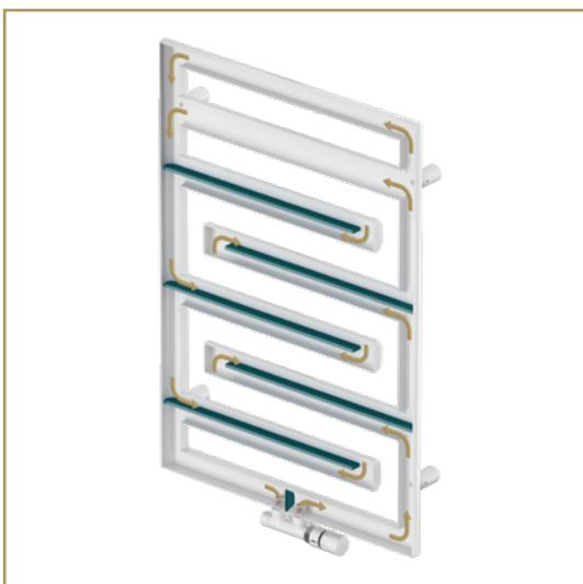
Das speziell entwickelte hydraulische Konzept des Heizkörpers und die innenliegenden Leitbleche optimieren den Wasserdurchfluss und erzielen die bestmögliche Heizleistung.
