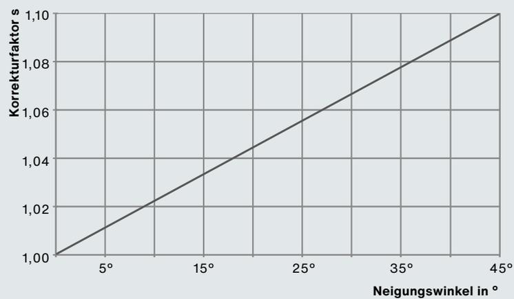
Zunahme der Gesamt-Wärmeleistung  $\dot{Q}_g$  bei Schräganordnung der Deckenstrahlplatten
