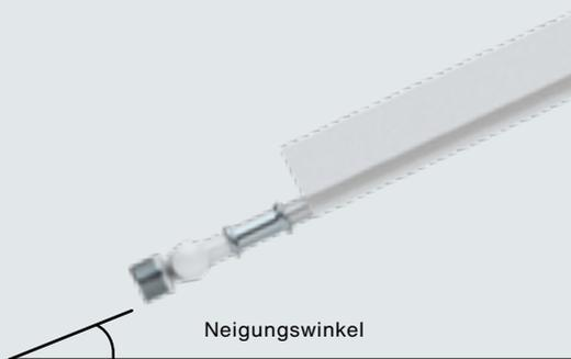
Schräganordnung in Längsrichtung der Deckenstrahlplatte
