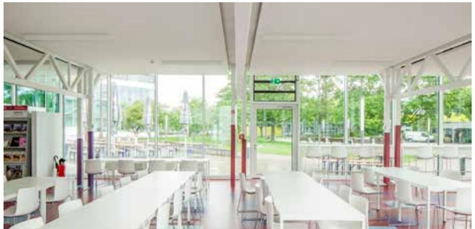
Die Zehnder Gipskartondecke absorbiert durch die perforierte Ausführung auftreffende Schallwellen und dämpft entsprechend die Geräuschkulisse im Mensagebäude.
