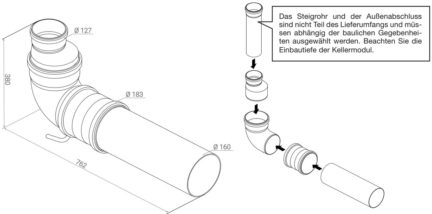
Bevor mit der Montage begonnen wird, müssen die Bauteile zusammengefügt werden. Stecken Sie die Bauteile gemäß der Darstellung fest bis zum Anschlag zusammen, um eine dichte Verbindung gemäß der linken Abbildung zu erhalten.
