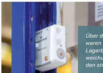
Über die gesamte Raumhöhe von sieben Metern – hier waren Messpunkte in drei Ebenen angebracht – trat im Lagerbereich von Ursapharm keine Temperaturabweichung von mehr als 1 °C auf. Dies entspricht damit den strengen Vorgaben von GMP und FDA.
