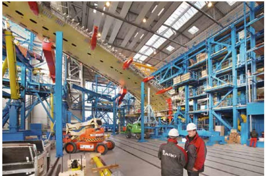
Wegen der äußerst sensiblen Messprozesse am Airbus 380 sind ungewöhnlich hohe Temperaturen gefordert. Auch bei fast 30 m Höhe lässt sich mit dem System ein homogenes Raumklima erzielen, bei gleichzeitiger hoher Energie- und Kosteneffizienz.
